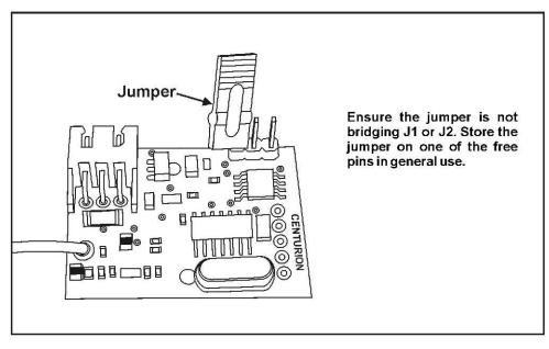
NB. ENSURE THE JUMPER DOES NOT BRIDGE J1 OR J2 WHEN ATTEMPTING TO LEARN THE MASTER REMOTE
