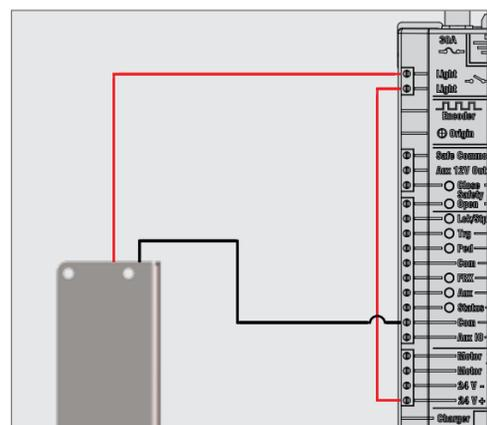
FIGURE 34 - D10 LIGHT RELAY CONNECTION
