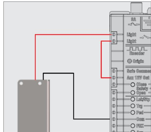
FIGURE 33 - D5-EVO LIGHT RELAY CONNECTION
