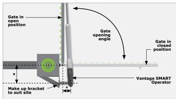
FIGURE 30. BRACKET POSITION - OUTWARD-OPENING GATE
