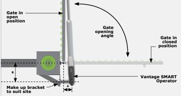
FIGURE 29. BRACKET POSITION - OUTWARD-OPENING GATE
