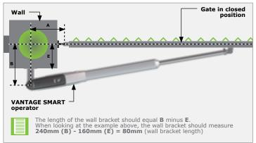
FIGURE 18. BRACKET POSITION - INWARD-OPENING GATE
