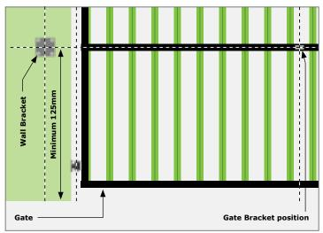
FIGURE 19. WALL BRACKET HEIGHT
