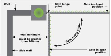
FIGURE 8. SIDE WALL LIMITATION FOR INWARD-OPENING GATE
