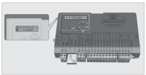
FIGURE 10. CONTROLLER LCD DISPLAY
